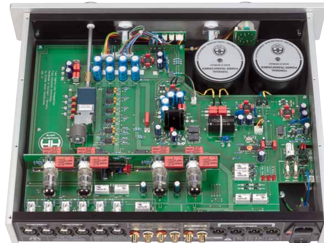
Im Bild vorne links sind (weiß) die Eingangsrelais mit hartvergoldeten Kontakten zusehen. Direkt darüber befindet sich die vollsymmetrische Röhren-Verstärkerstufe mit je zwei Doppeltrioden 7025/E83CC pro Stereokanal. Ganz oben links die Siebkondensatoren und rechts die Trafos
